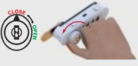
2. ROTATE THE KNOB TO CLOSE POSITION. หมุนมือจับไปที่ตำแหน่งปิด
