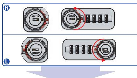
Drehknopf gegen den Uhrzeigersinn zurückdrehen bis zum Anschlag. Codierpin springt in Ausgangsstellung zurück.
