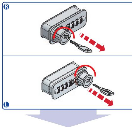
Drehknopf auf bestehender Position festhalten und NUR den Schlüssel gegen den Uhrzeigersinn  $180^\circ$  zurückdrehen und entnehmen.
