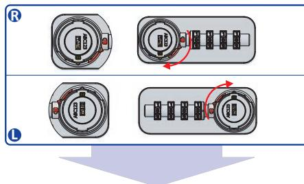
Drehknopf im Uhrzeigersinn bis zum Anschlag weiterdrehen. Code springt auf „0000“.
